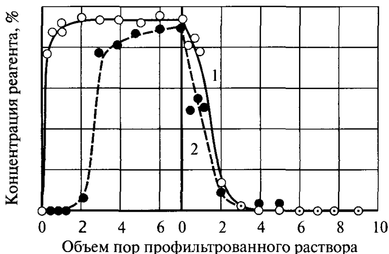
Рис. 7.4. Изменение концентрации ИСБ-1 в процессе адсорбции и десорбции в зависимости от объема пор профильтрованного раствора: 1 - кварцевый песок; 2 - теригенная порода Таймурзинского месторождения.
