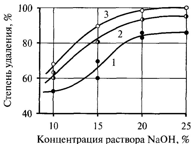
Рис. 8.1. Полнота удаления гипсовых отложений в зависимости от концентрации действующего раствора едкого натра. Время реакции: 1 - 30 мин.; 2 - 60 мин.; 3 - 90 мин.
