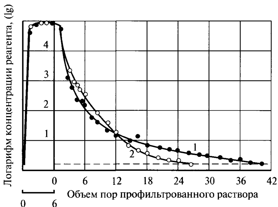
Рис.7.7. Адсорбция и десорбция ингибирующих композиций на основе НТФ: 1 - 5% НТФ с оксидатом; 2- 5% НТФ с соляной кислотой (по данным Ю. В. Антипина и др., А. с. 1713899).
