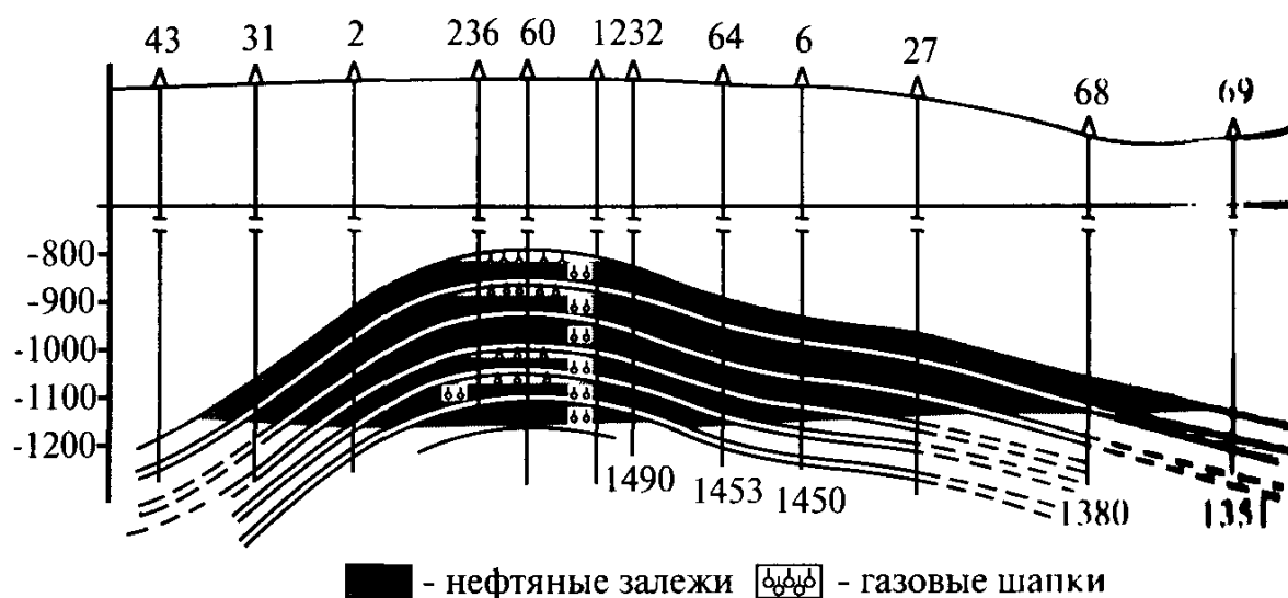
Рис. 11.17. Геологический профиль многопластового месторождения Узень.
